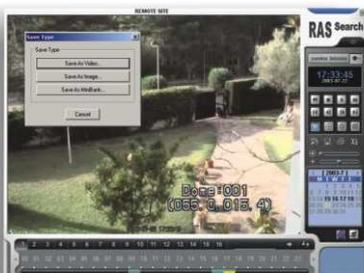
Proporciona una función de búsqueda remota para imágenes grabadas del ADR y una función de reproducción para las imágenes buscadas. Además proporciona varias funciones adicionales incluyendo zoom, interpolación de la imagen, volcado de imágenes e impresión de un fichero de imagen.
