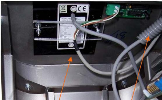
Detalle de fijación vista desde el interior de la lectora de un 8213
