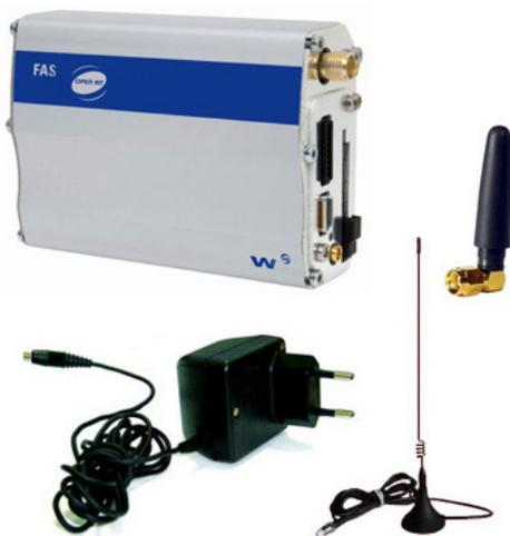
El **W-FAS** es un equipo industrial de alto rendimiento, especialmente indicado para realizar comunicaciones celulares **GSM/GPRS** con equipos remotos en **entornos Industriales** con alto nivel de exigencia. Diseñado para ofrecer una alta fiabilidad y disponibilidad, es ideal para trabajar 24 horas al día los 365 días del año, sus características técnicas y su gran robustez así lo demuestran.
